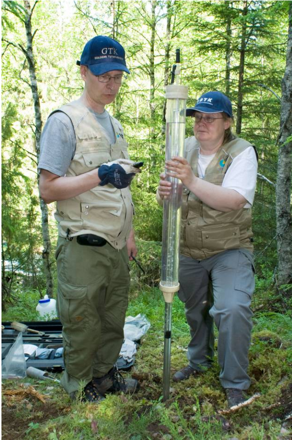
Kuva 13. Maaperän vedenläpäisevyysmittausta Mansikkakuopan tutkimusalueella. Kuva: Jari Väättäin GTK.
