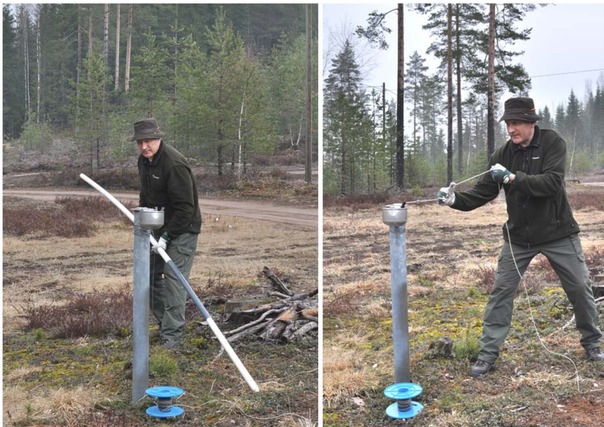
Kuva 8. Mansikkakuopan pohjaveden havaintoputken (MV3) Slug-testissä pohjaveden syrjäyttämiseen käytetty nelimetrinen muovinen tanko (vasemmalla), joka mittausprosessissa tempaistiin ylös nopeasti (oikealla). Kuvat S. Luoma GTK.
