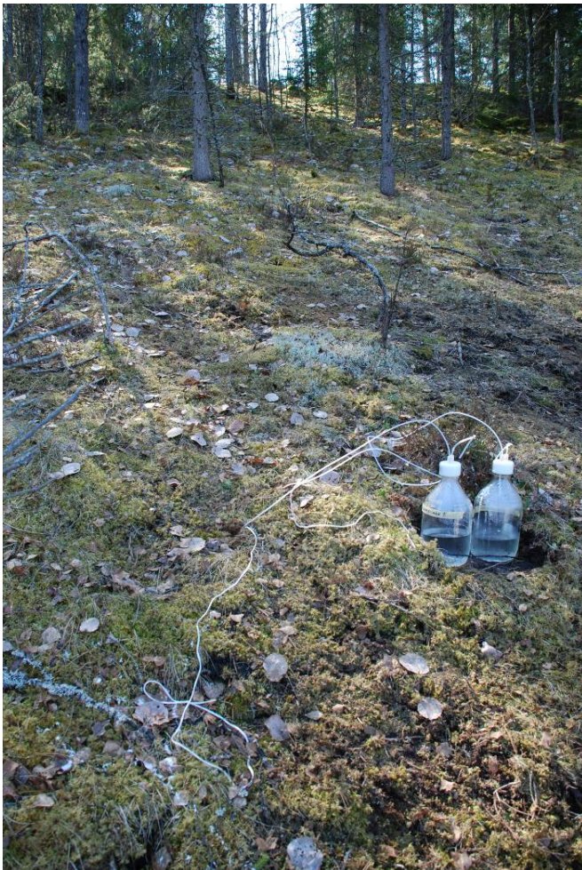
Kuva 14. Kaksi imulysimetrinäytteenoton pulloa Mansikkakuopan trap-radalla. Pulloihin on imetty alipaine. Pulloista lähtevät letkut on kiinnitetty kahdella eri syvyydellä oleviin vajoveden keräimiin. Kuva: Timo Tarvainen GTK
