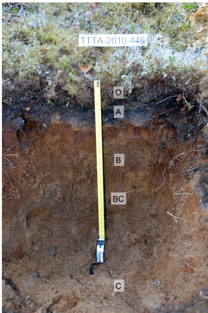
Kuva 12. Maaperäprofiili, jossa näkyy pinnalla humuskerros (O), sitten tumma huuhtoutumiskerros (A), sen alla ruskea rikastumiskerros (B), vaihettumisvyöhyke (BC) ja pohjalla muuttumatonta harmaata pohjamaata (C). Kuva: Timo Tarvainen GTK.
